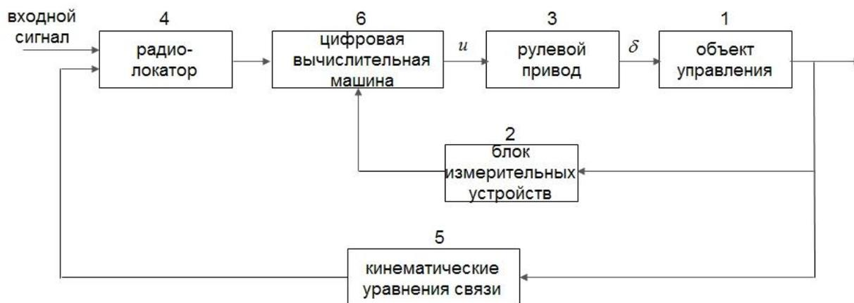
Рисунок 8 – Блок-схема системы управления
